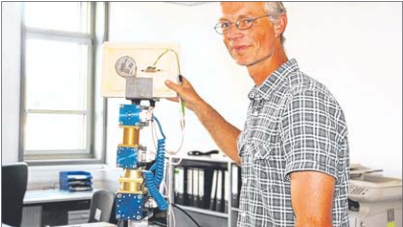
Die von Jörg Schröter entwickelte Infusionspumpe ist an einem elektrischen Arm befestigt, der Bewegungen des Körpers nachstellt. Foto: Rische
